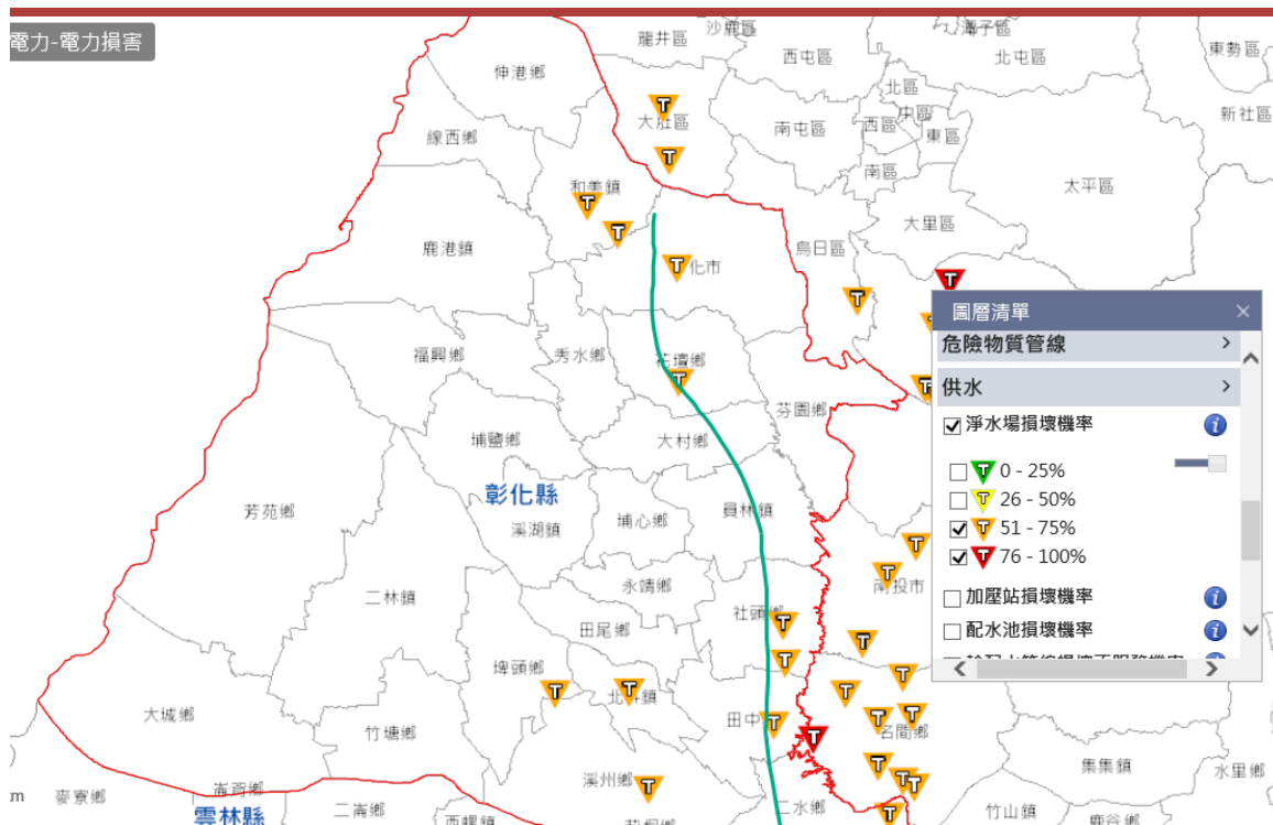
圖 1-3-10 模擬淨水廠損壞機率
